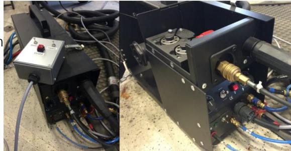
Drahtvorschubkoffer mit integrierter HF-Zündung, Steuerung und Anschlusschnittstellen
