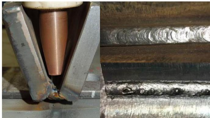
Versuchsschweißung mit Nahtoberfläche, Wurzel und Härteverlauf
