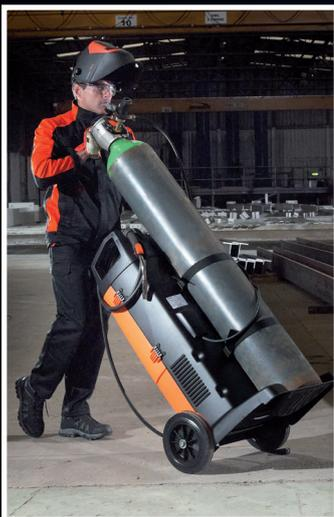
Das **GasMate-Gehäusedesign** erleichtert das Einsetzen und Aufbewahren der Gaszylinder sowie das Bewegen der Maschine. Die Gaszylinder werden auf Bodenebene eingesetzt und mit starken Gewebegurten gesichert.
