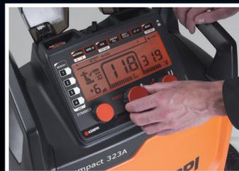
Das **große und übersichtliche LCD Panel** erleichtert die Parametereinstellung. Ein Ablagefach für Verschleißteile bietet einfachen Zugang.
